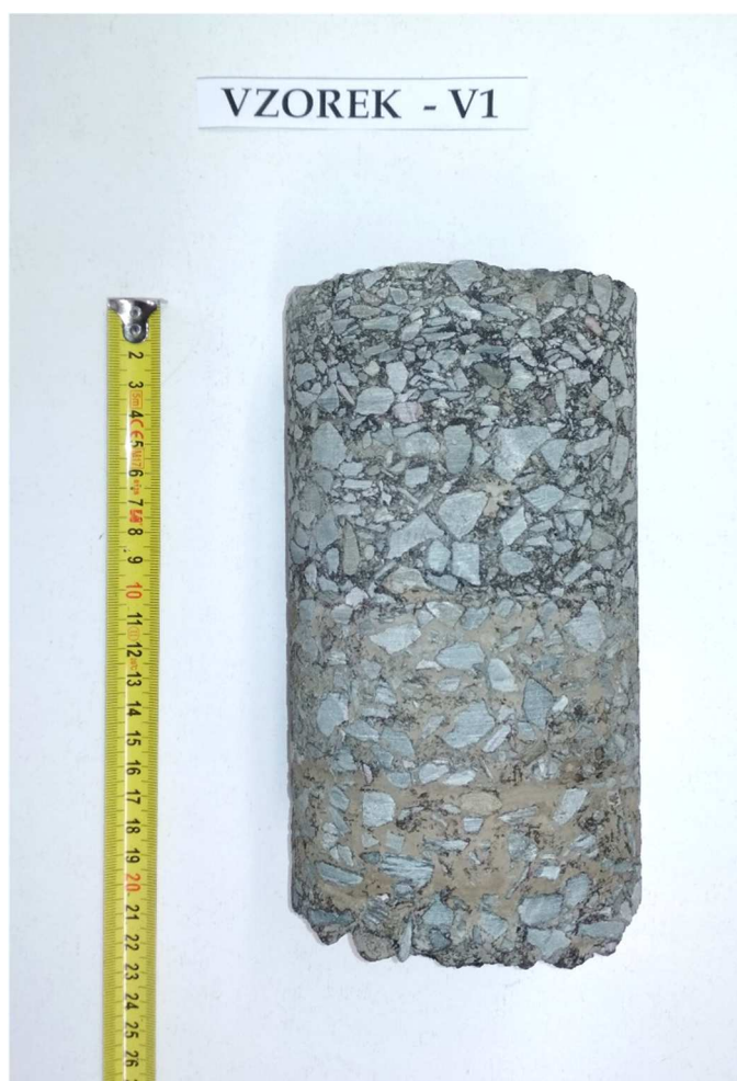
Obr. 2 - Jádru vývrtu Vzorek – V1 (laboratoř).
