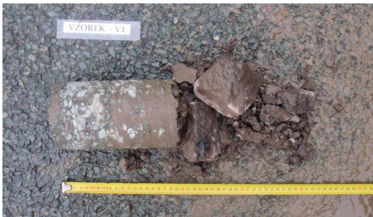
Obr. 1 - Jádro vývrtu Vzorek – V1 (in situ).
