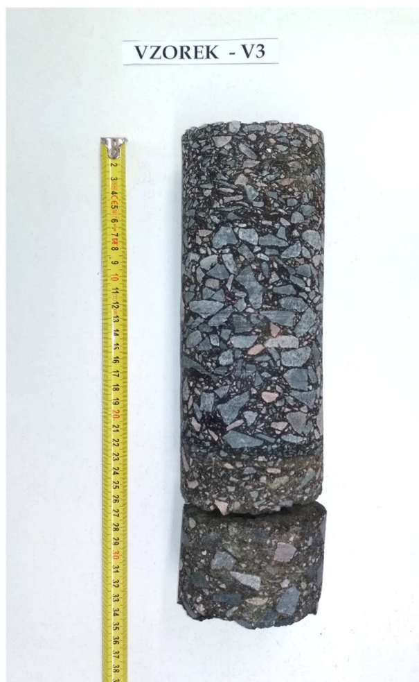
Obr. 6 - Jádru vývrtu Vzorek – V3 (laboratoř).
