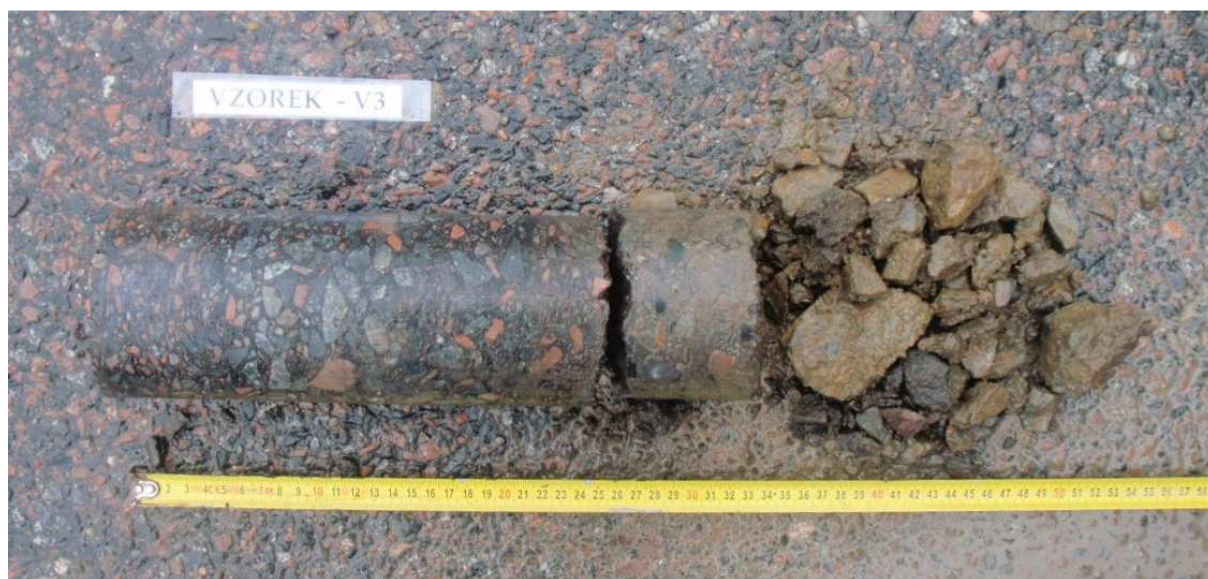
Obr. 5 - Jádro vývrtu Vzorek – V3 (in situ).
