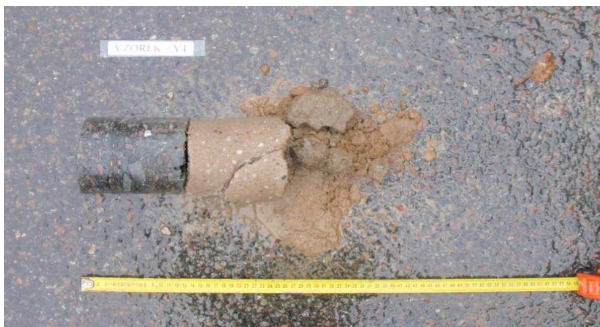
Obr. 7 - Jádro vývrtu Vzorek – V4 (in situ).
