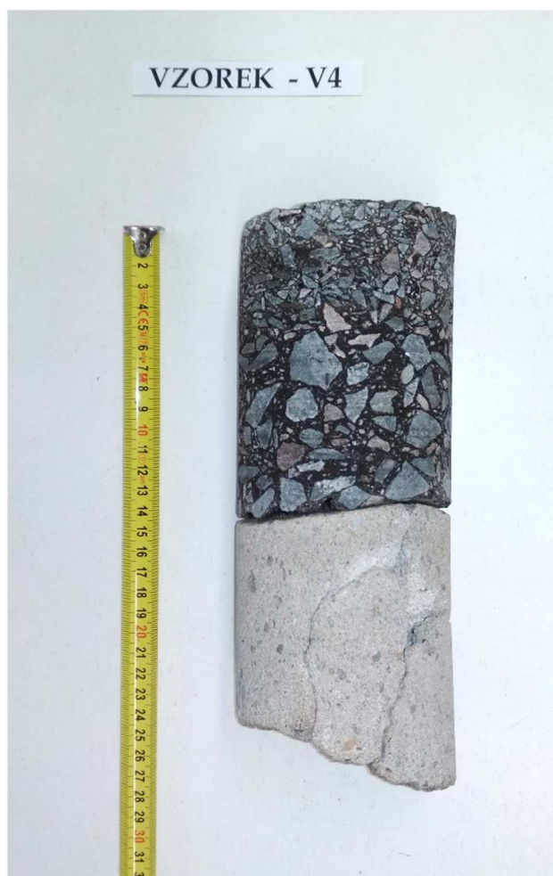
Obr. 8 - Jádro vývrtu Vzorek – V4 (laboratoř).
