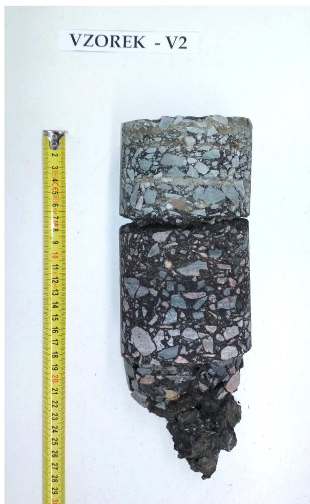
Obr. 4 - Jádro vývrtu Vzorek – V2 (laboratoř).
